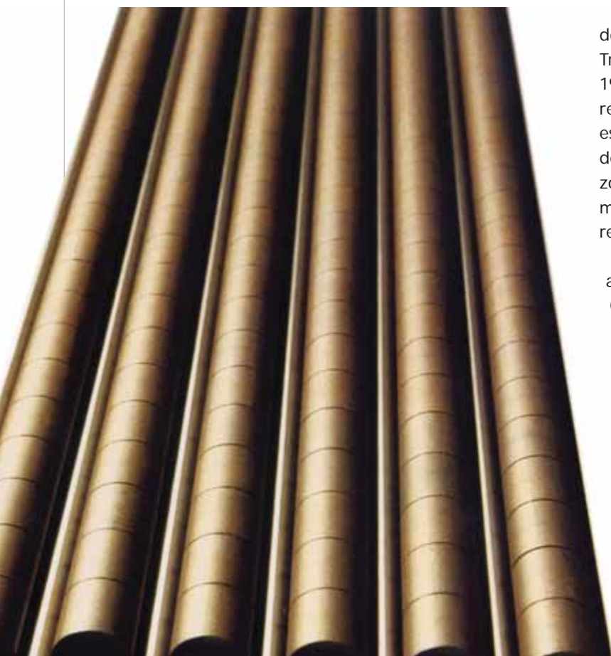
Um feixe de varetas metálicas forma um invólucro totalmente vedado de cinco metros de altura, onde são encapsuladas as pastilhas de urânio.
