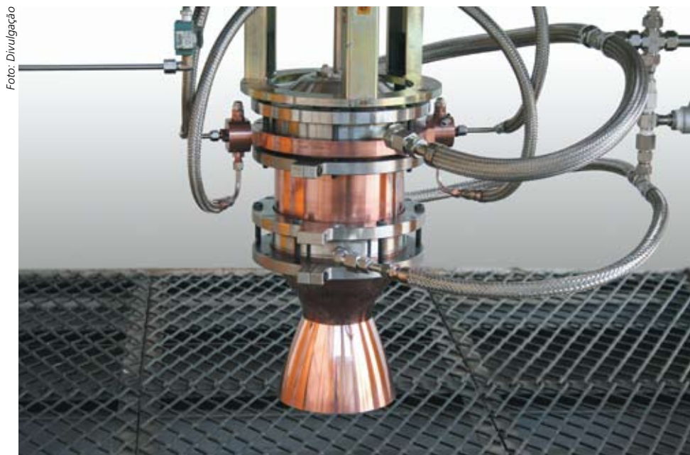
O motor-foguete de propelente líquido - L15 é o mais novo produto desenvolvido pela Orbital em parceria com o Instituto de Aeronáutica e Espaço (IAE)
