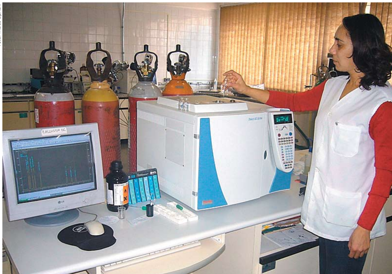
Pesquisa de avaliação de carboidratos é feita com a ajuda de um cromatógrafo gasoso acoplado a um espectômetro de massa
