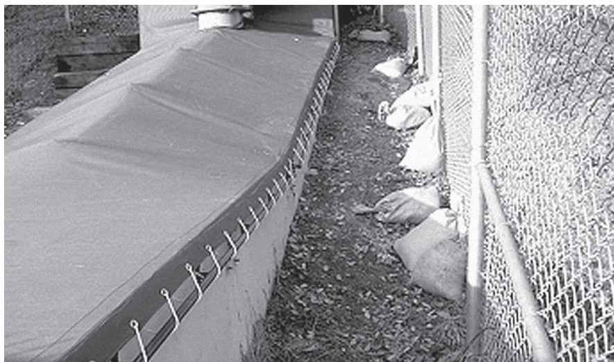
Figura 5.3 Dispositivo LR3 US-101, com a sua cobertura.
