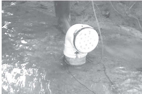
Figura 2.18 Amostrador fixo de coleta simples.
