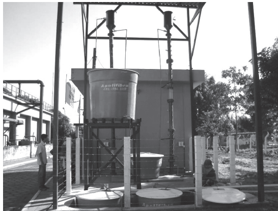
Figura 11.6 Reator híbrido de filme fixo (anaeróbio – aeróbio)
