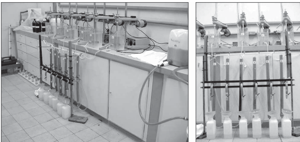
Figura 8.2 Instalações de bancada (jarteste e FLA) utilizadas nos estudos de tratabilidade da água bruta afluente à ETA de dupla filtração.
