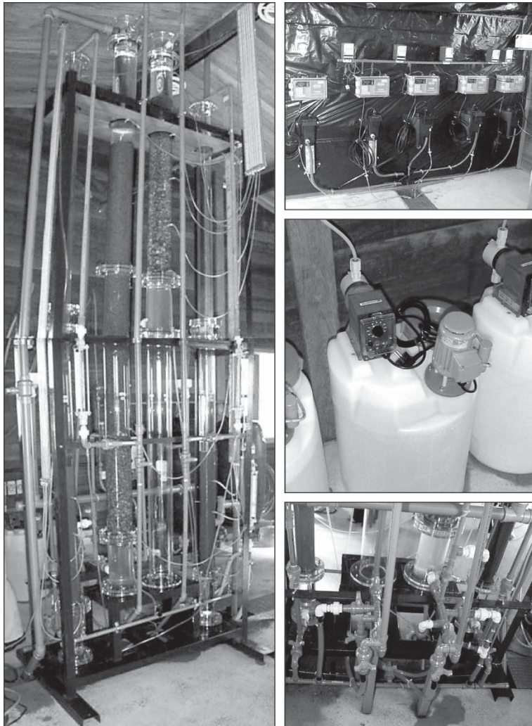
Figura 4.24 Vista geral e detalhes da instalação-piloto da EESC-USP: colunas de filtração (esquerda), turbidímetros em linha (direita acima), bomba dosadora (direita meio) e interligações dos filtros (direita abaixo).
